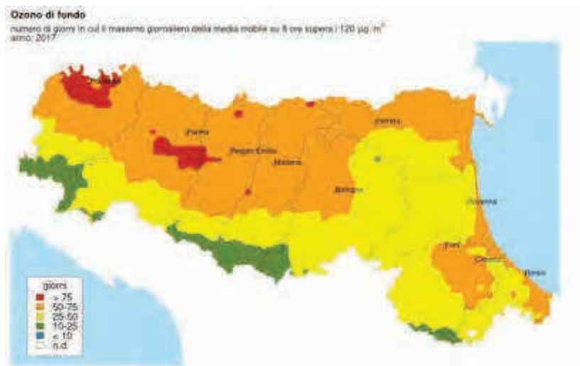
Figura 43b. Valutazione modellistica del numero di superamenti del VL per il massimo della media mobile sulle 8 ore della concentrazione di ozono di fondo nel 2017.
